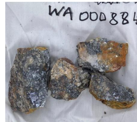
Galena rich quartz vein, assayed, 65g/t Ag, 20.5% Pb and 0.3g/t Au (Tiberius)
