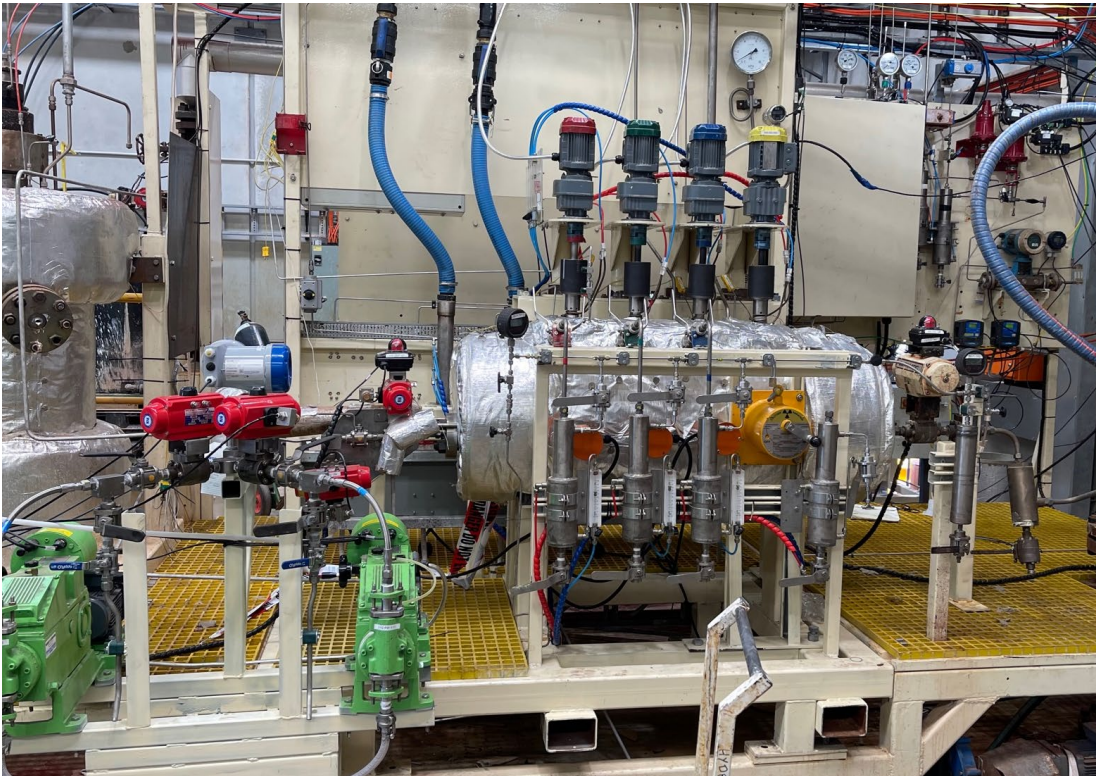
Figure 3: Pressure Leaching in Autoclave at ALS
