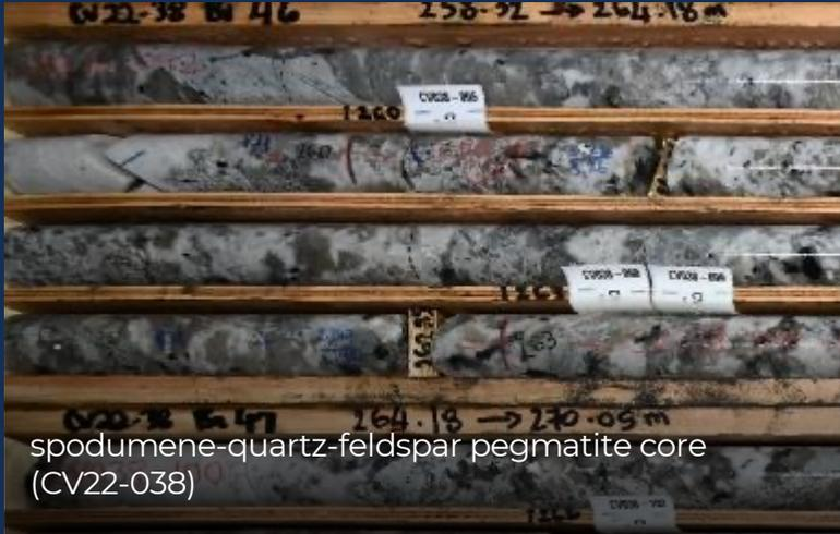
spodumene-quartz-feldspar pegmatite core (CV22-038)
