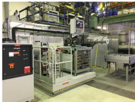
Großextruder 300 bar instrumentiert
