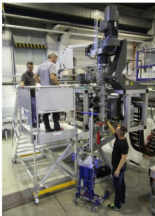
Großextruder 300 bar instrumentiert
